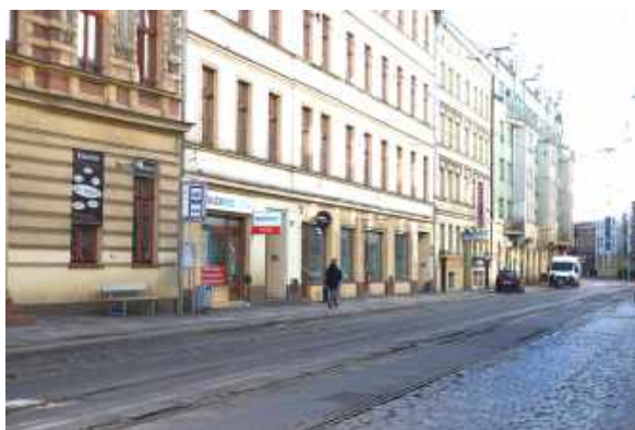
Rys. 49. Przystanek tramwajowy bez wiaty i podwyższenia jezdni, brak miejscowego obniżenia krawężnika. Szczynicka, Wrocław (zdj. autor)
