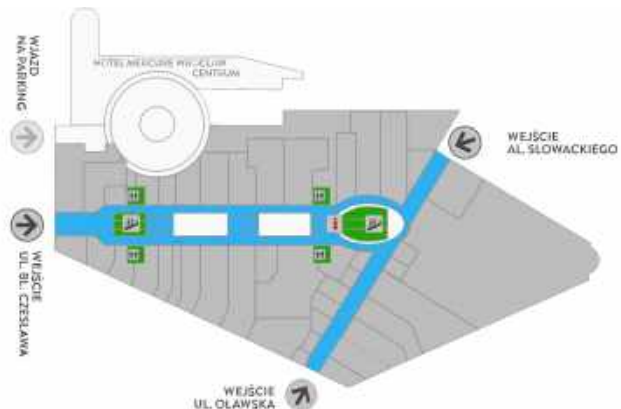
Rys. 66. Centrum handlowe Galeria Dominikańska we Wrocławiu, prosty układ i czytelność ciągów komunikacyjnych poziomych i pionowych, pomiędzy przeciwległymi wejściami odległość wynosi ok. 100-160 m, Rzut poziomy „0” (oprac. własne na podst. Plan Galerii , źródło internetowe: http://galeria-dominikanska.pl/plan.html [dostęp: 10.05.2019])
