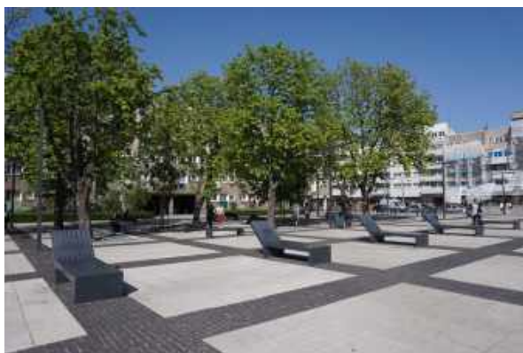
Rys. 52. Siedziska uniemożliwiające korzystanie z nich osobom starszym – bardzo niskie, bez oparcia, bez podłokietników, wykonane z metalu (który latem, nagrzany w słońcu osiąga bardzo wysokie temperatury). Plac Nowy Targ, Wrocław, realizacja 2013 (zdj. autor)
